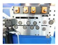
Configuración de los rodillos de enderezado con distribución variable para materiales de espesor delgado, medio y alto así como materiales de alto límite elástico que permiten un perfecto enderezado con un minimo esfuerzo.
